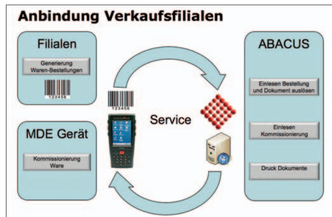
Auf dem Kassenserver werden alle Filialbestellungen gesammelt und dann für das Einlesen in die Abacus-Auftragsbearbeitung aufbereitet
